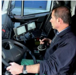
El equipo cuenta con un sistema de mando de control lógico programable según el protocolo de comunicación CAN-Bus.
