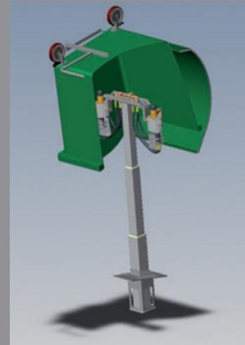
El lavado del contenedor se realiza dentro de una cámara realizada en acero inoxidable, totalmente estanca.
